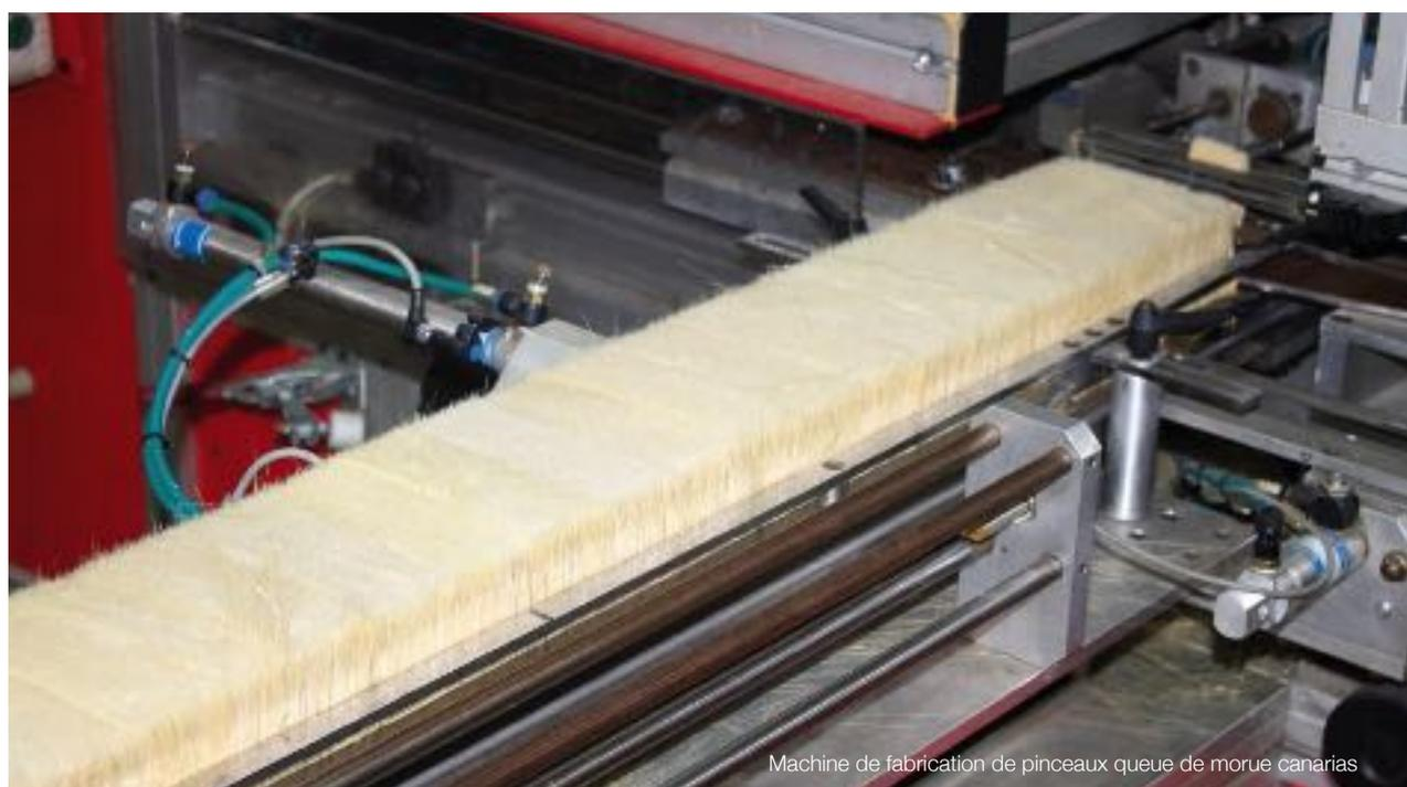
Machine de fabrication de pinceaux queue de morue canarias
